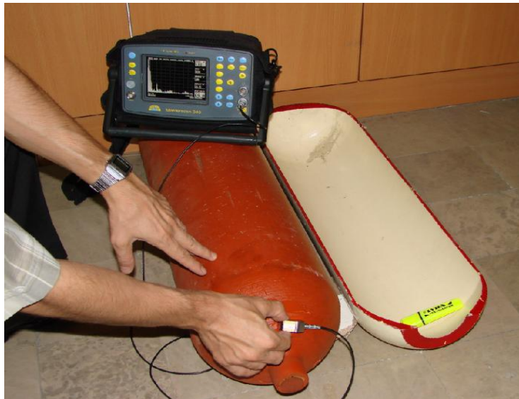
شکل ۱: تست فراصوتی یک سیلندر CNG به روش دستی، یک سیلندر برش خورده هم در تصویر مشاهده می‌گردد.
